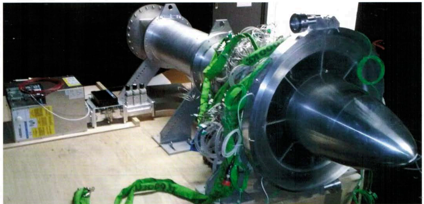
Figure 9 : Maquette instrumentée (avec à gauche le système de chauffage)
