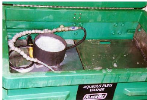
Figure 5 : Systèmes à Immersion
