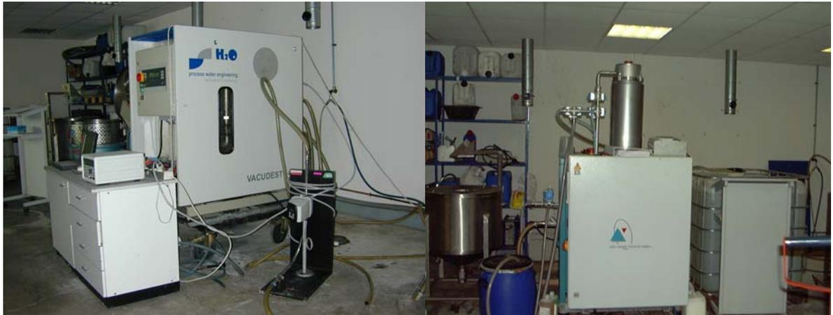
Figure 25 : Evaporateur à compression mécanique de vapeur, débit à l'eau 40 l/h
