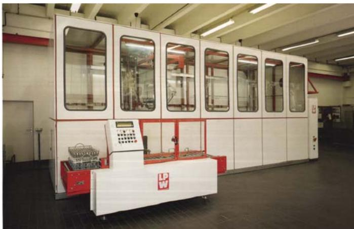
Figure 6 : Système de nettoyage par immersion multi-cuves
