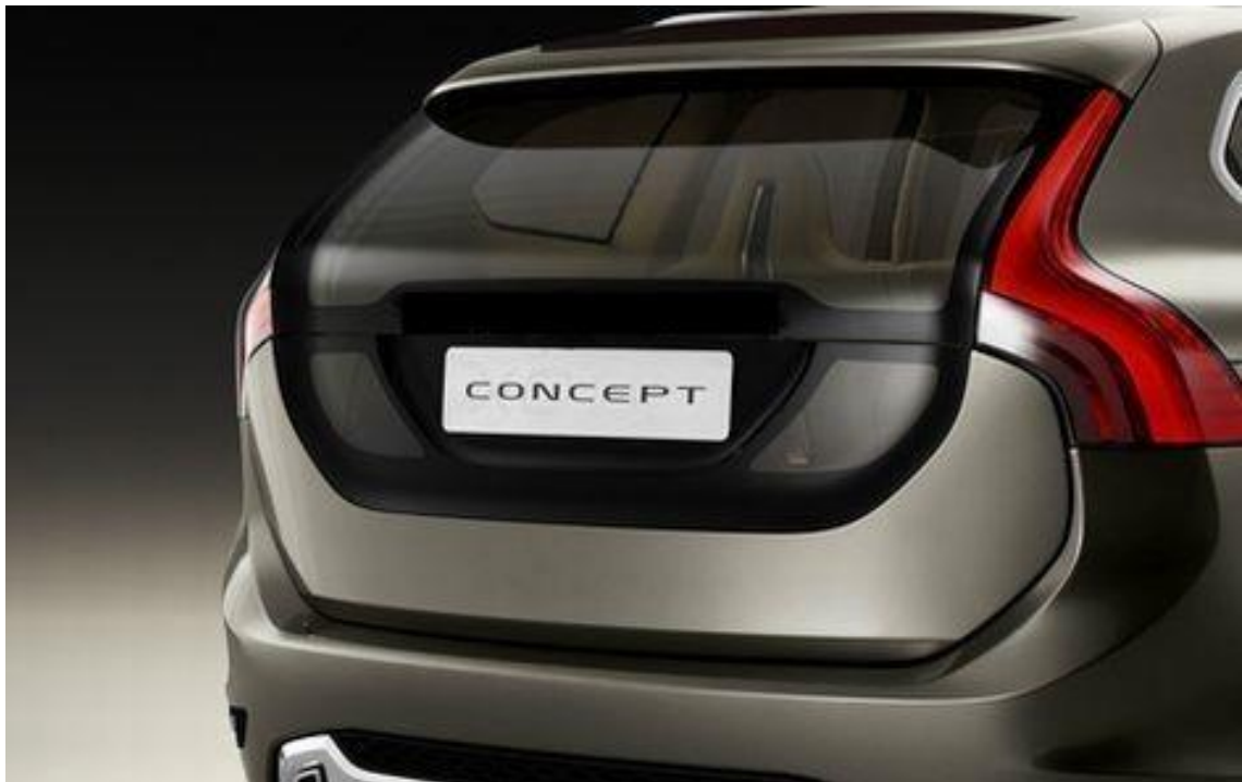
Photo 1 : Nouveau hayon composite/thermoplastique testé avec INDAR dans le cadre du projet ECODISM
