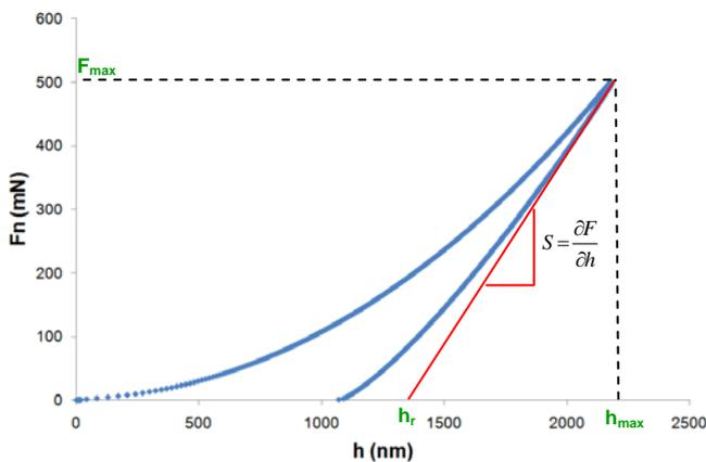
L'aire de contact  $A_c$  entre l'indenteur et l'échantillon est défini pour la mesure de la dureté et du module élastique par la relation :
