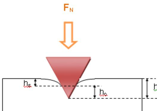
Durant un test d'indentation un système d'acquisition enregistre la force appliquée en fonction de la profondeur de pénétration de la pointe. Ces deux paramètres sont continuellement mesurés lors d'une phase de charge et d'une phase de décharge. Le résultat est une courbe charge-déplacement.
