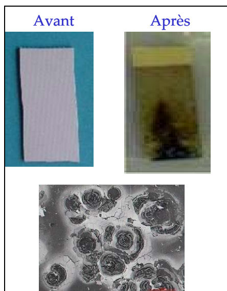
Figure 45 : Exemple de matériaux polymères dégradés par les lampes flash
