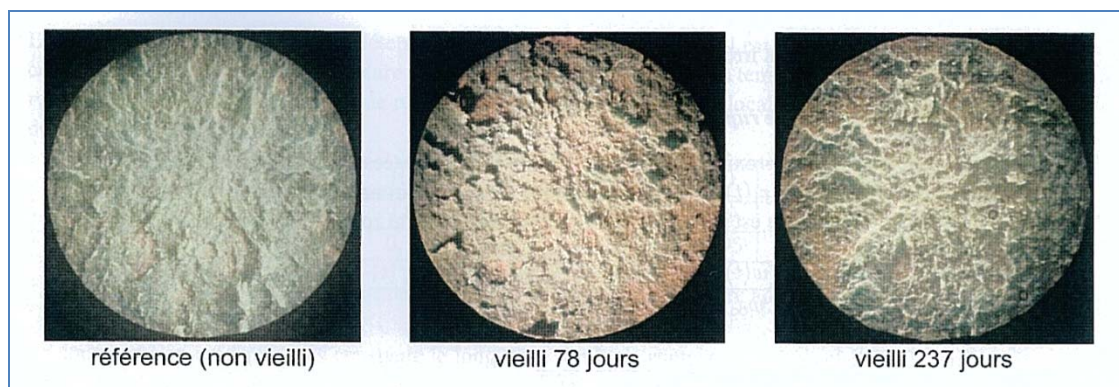
Figure 35: Evolution du faciès de rupture après vieillissement hygrothermique d'assemblages avec des substrats en aluminium
