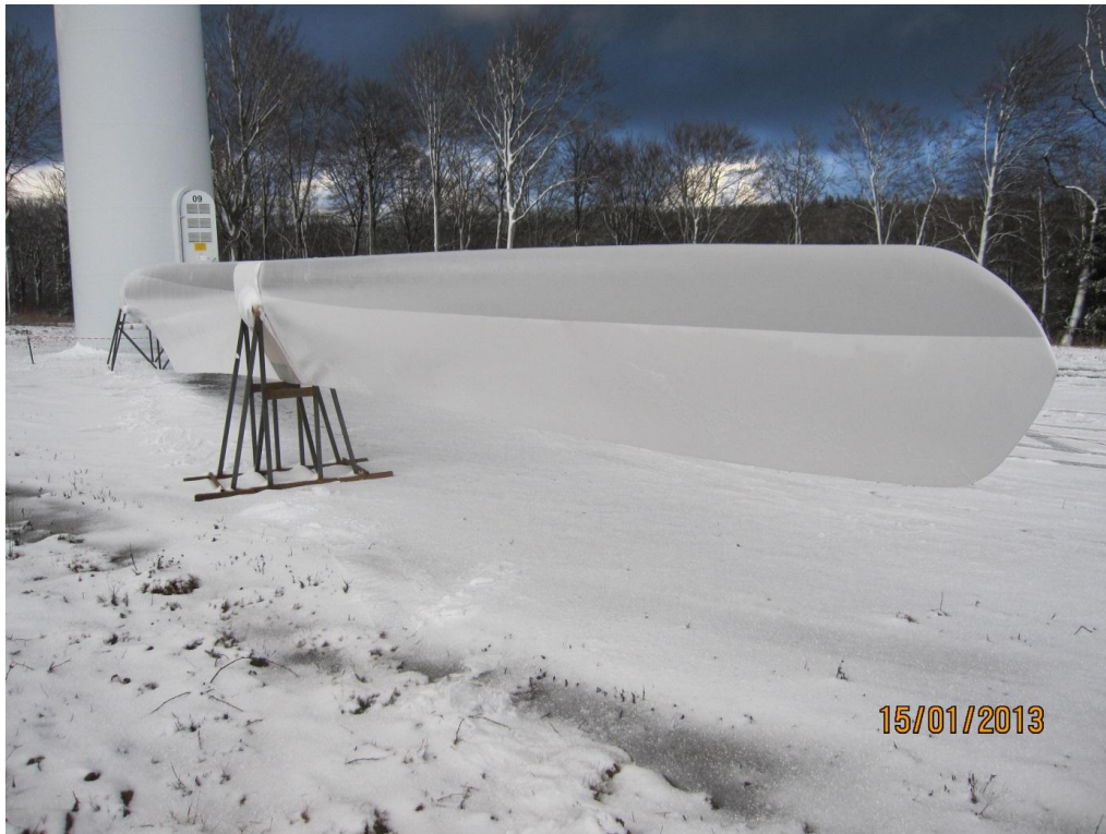
Figure 2 : pale au sol équipée du système de dégivrage.
