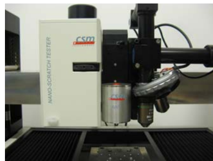
RESCOLL est équipé d'un appareillage de nanoindentation de la société suisse CSM
