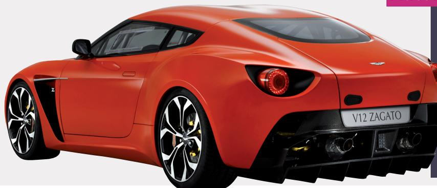
Les panneaux de carrosserie en composite carbone de la Zagato V12 AML, du constructeur Aston Martin, sont collés sur un châssis en aluminium et acier grâce à un adhésif méthacrylate.
