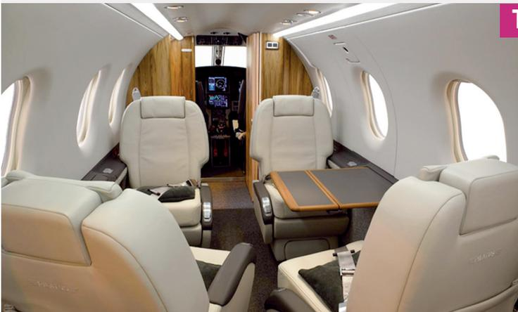
Mousses, cuir, nylon : des adhésifs se substituent à la couture ou aux formules à base de solvants. Ici, l'intérieur d'un avion de plaisance collé grâce à un produit du suisse Collano.
