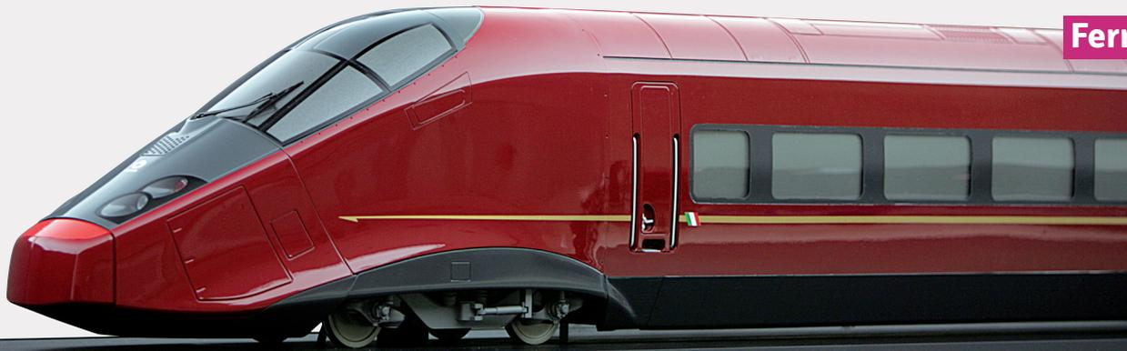
Alstom a choisi une colle méthacrylate pour fixer le nez et les lignes de fuite de l'AGV. Sa résistance au pelage est suffisante pour endurer des vitesses de 350 km/h.
