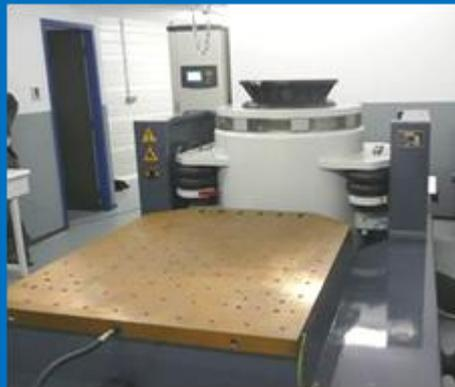
Fig 3 : Vibreur 60kN couplé à sa table
