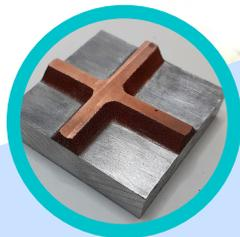
Cuivrage localisé pour optimisation de la conduction thermique et électrique.
