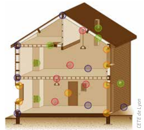
Les fuites peuvent être situées au niveau du gros-œuvre et des éléments de structure, des menuiseries extérieures, des trappes et éléments traversant les parois et des équipements électriques et réseaux fluides.
