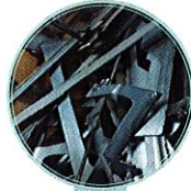
Récupération de chutes de production de composites d'un Airbus A350
