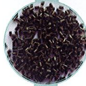
Fabrication d'un composé à 90% matrice plastique et 10% broyats composites
